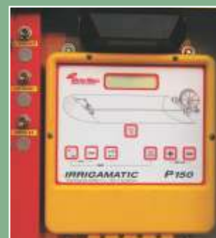
Painel eletrônico de controle de velocidade
