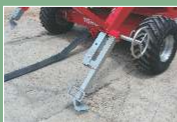
Redutor mecânico para levante das âncoras e sistema de entrada de água pelo chassi
